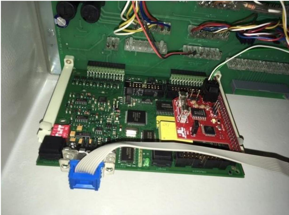
**Achtung!** Auf richtigen Einbau achten. Es ist mechanisch möglich, die Adapterplatine zu weit links oder rechts in die Buchse auf dem Mainboard zu stecken. Es dürfen an der Seite keine PINs sichtbar bleiben. Die Installation darf nur im spannungsfreien Zustand der Zentrale vorgenommen werden.
