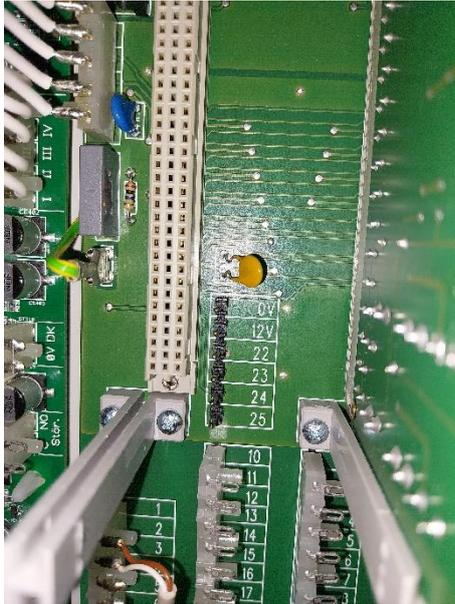
Abbildung 5: Blick auf die Steckerleiste für Anschluss Programmierstick
