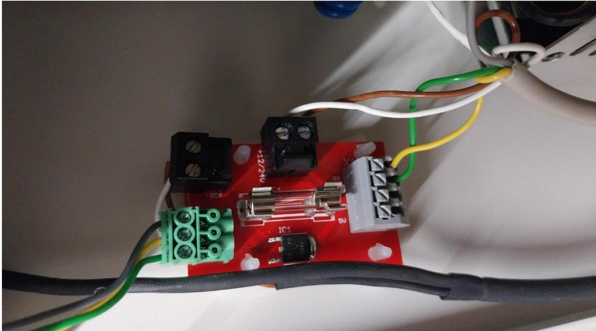
Abbildung 13: Adapterplatine mit Zentrale verbinden
