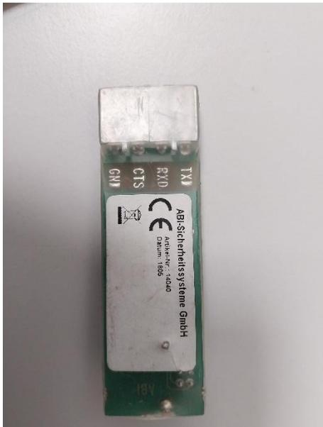
Abbildung 6 Beschriftung auf dem Programmierstick zeigt an TX, RX
