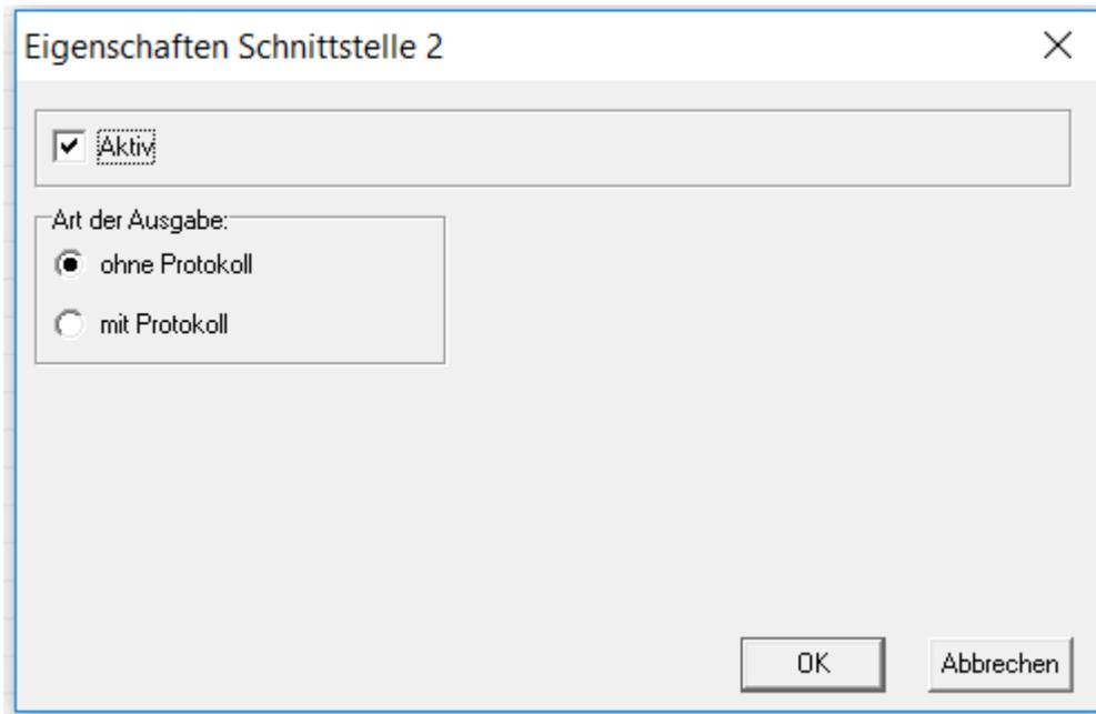
Dort den Haken „Aktiv“ setzen und die Ausgabe ohne Protokoll einstellen. Danach die Programmierung zur Zentrale laden und die Schnittstelle ist aktiviert. Bitte denken Sie beim Programmieren an den DIP3 und an das m-m Kabel.
