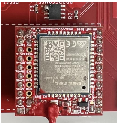
Abbildung 7: LTE-Modul mit SIM für Wartungsbox V4
