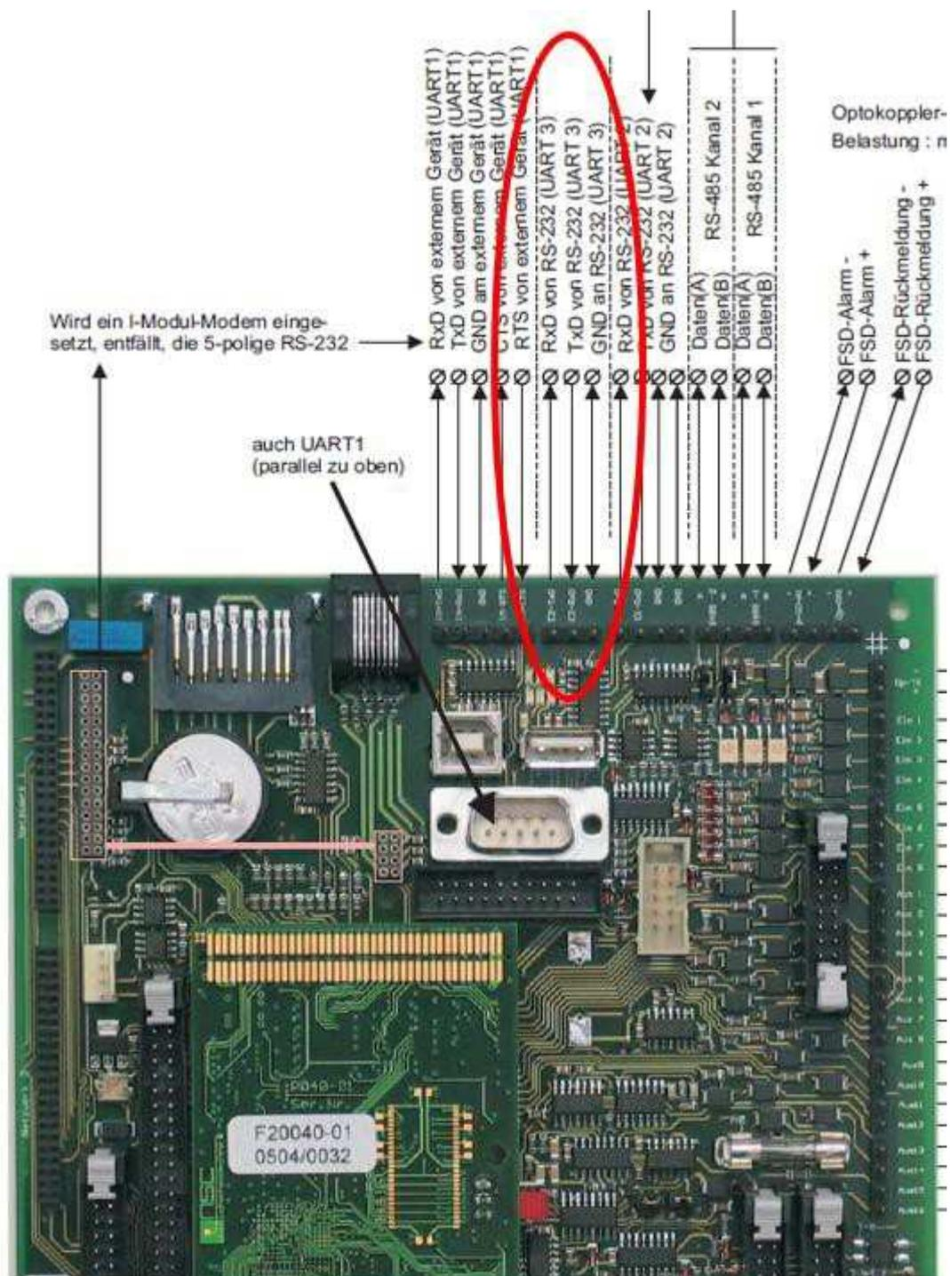
Anschluss der Wartungsbox über die Pins der UART3. Dabei ist GND das graue Kabel an der Wartungsbox. Die Spannungsversorgung der Wartungsbox kann über einen freien Anschluss direkt am Netzteil (24V) erfolgen.
