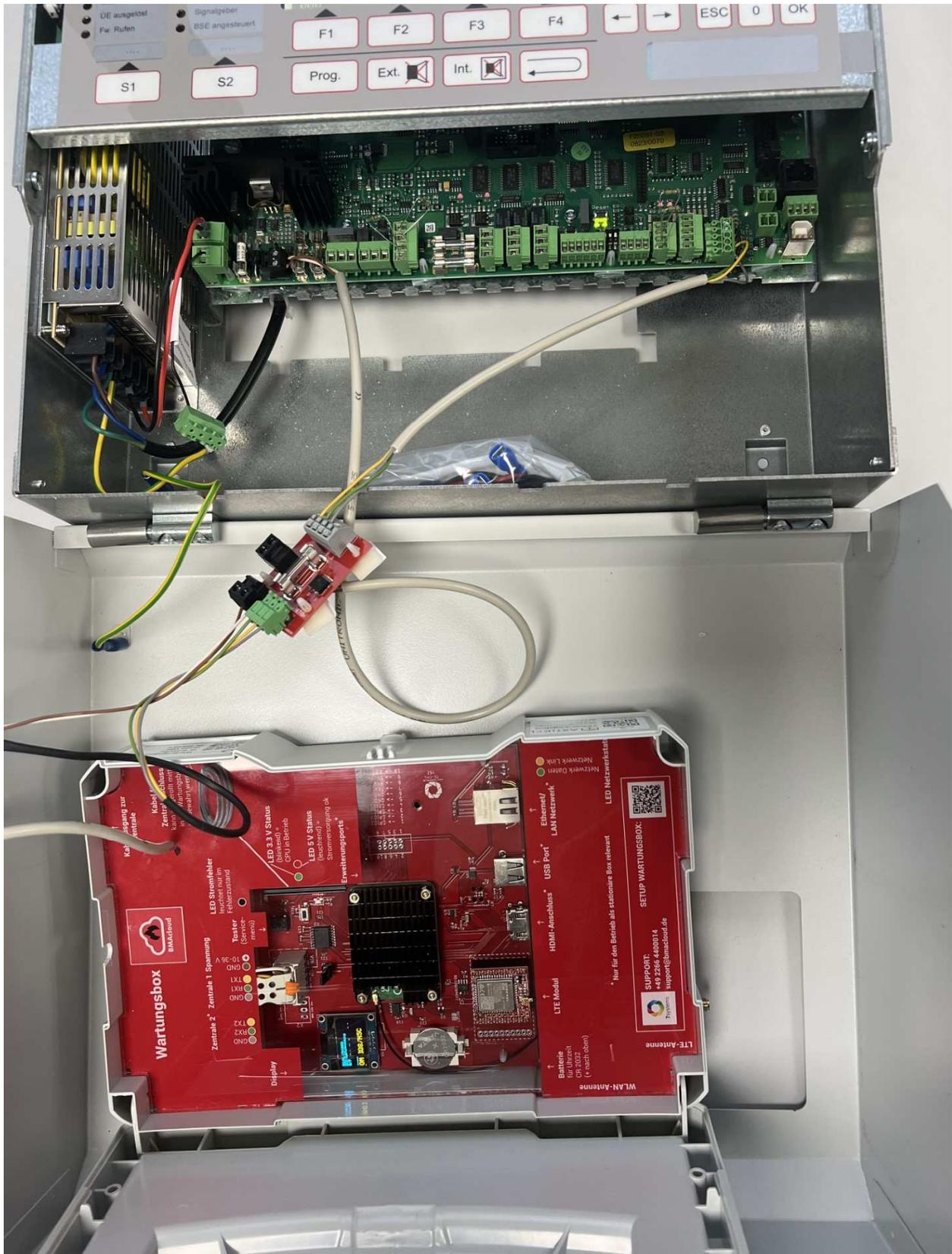
1. Als erstes sollten die Stecker der Wartungsbox und der Zentrale an die Adapter-Platine eingesteckt werden (siehe unten die Abbildung)
