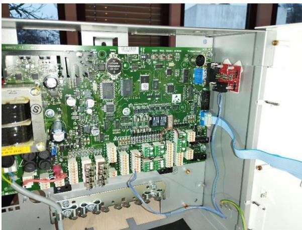
*Abbildung 2 sub-d adapter auf rs232 schnittstelle aufgesteckt*
