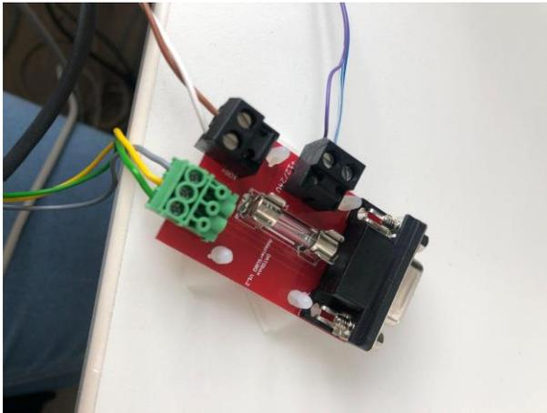
*Abbildung 1 sub-d Adapter für Anschluss an Complex RS232 Schnittstelle*
