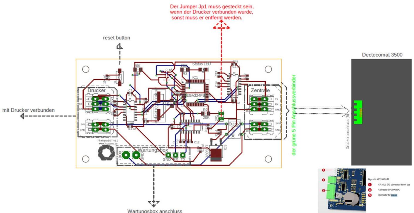
Der Adapter kann mit dem inkludierten Kabel/Stecker an den Drucker der DECT3500 angeschlossen werden.
