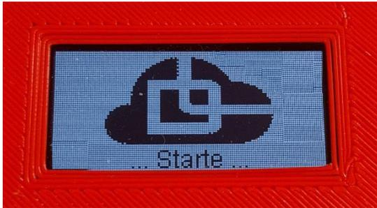
Es dauert ca. 30 Sekunden bis nach dem aufstecken der Spannungsversorgung das Display eingeschaltet wird. Auf dem OLED-Display der Box können 6 Zeilen Text angezeigt werden. Diese sind wie folgt unterteilt:
