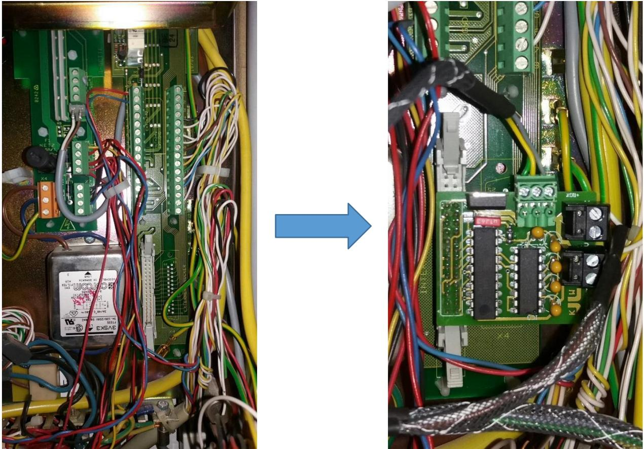
**Achtung!** Auf unsymmetrischen Einbau achten. Es ist mechanisch möglich, die Adapterplatine zu weit links oder rechts in die Buchse auf dem Mainboard zu stecken. Die Installation darf nur im spannungsfreien Zustand der Zentrale vorgenommen werden.
