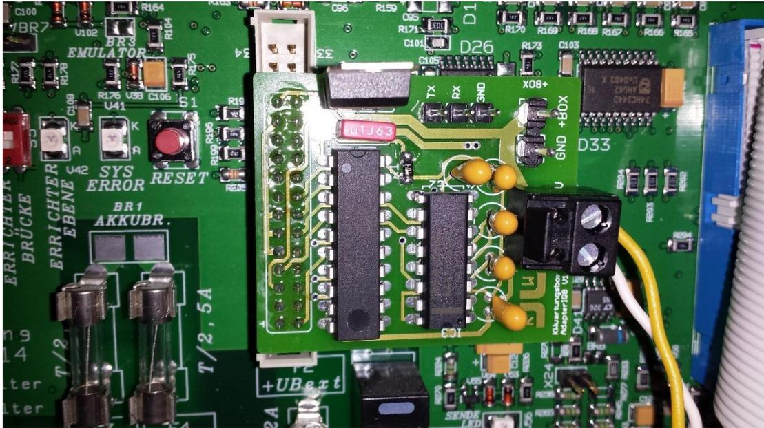
**Achtung!** Auf unsymmetrischen Einbau achten. Es ist mechanisch möglich, die Adapterplatine zu weit links oder rechts in die Buchse auf dem Mainboard zu stecken. Die Installation darf nur im spannungsfreien Zustand der Zentrale vorgenommen werden.
