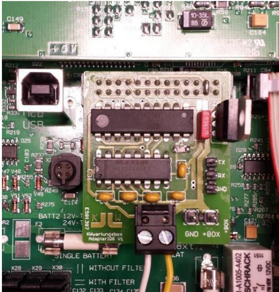
**Achtung!** Auf mittigen Einbau achten. Es ist mechanisch möglich, die Adapterplatine zu weit links oder rechts in die Buchse auf dem Mainboard zu stecken. Die Installation darf nur im spannungsfreien Zustand der Zentrale vorgenommen werden.
