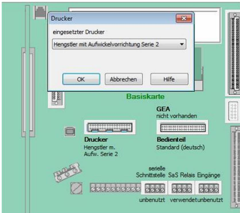
Es muss nur auf der Druckerschnittstelle des Mainboard der entsprechende Punkt angeklickt werden und der im Bild angegebene Typ ausgewählt werden.
